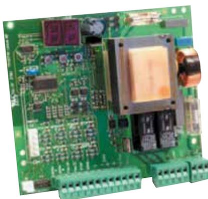
Cuadro de Control para accionamientos de puertas correderas 230V. Tensión de alimentación 230V. Carga máxima de motor 1000W. Programación con display. Lógica de funcionamiento Manual/Automática/Automática paso-paso / Seguridad / Semiautomática B / Presencia operador / Semiautomática paso-paso. Tiempo de apertura y de pausa ajustable de 0 a 4 min. Fuerza motor ajustable entre 50 niveles. Posibilidad de conectar un encoder. Contador de maniobras.
