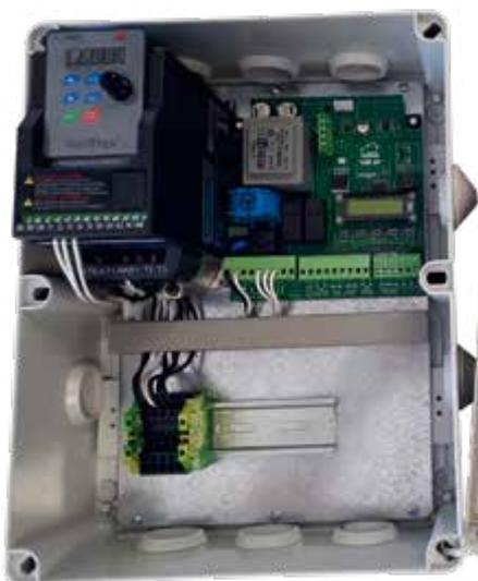
Cuadro de control programable con variador que permite la instalación de accionamientos trifásicos a puertas donde solo se dispone de alimentación monofásica 230 V.
