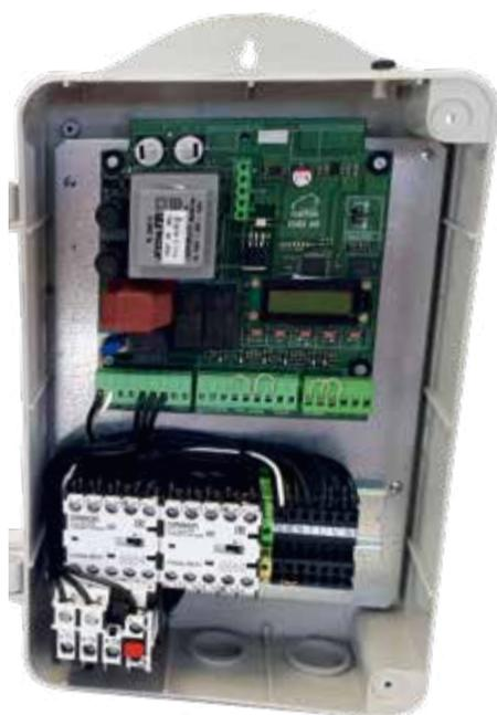
Cuadro de control programable para puertas basculantes con accionamientos trifásicos. Alimentación 230 V 3Ph - 380V 3Ph. Carga máxima del accionamiento 1200 W. Lógicas de funcionamiento programables. Tiempos de apertura, cierre y pausa programables. Protección IP 54. Programación por display.
